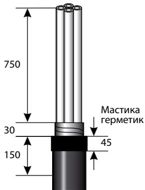
**1.** Удалите наружный покров кабеля. Для кабеля с броней дополнительно удалите наружный покров на длине 30мм. Зачистите и обезжирьте броню и наружный покров на длине 150мм. Лентой эластичного герметика оберните наружный покров кабеля.
